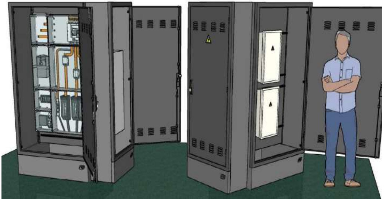
Figura 6. Detall armari prefabricat instal·lació d'enllaç
